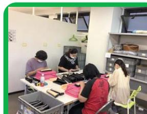
自動車用の肘掛け部品に、クッション材として使用されるスポンジを、型に沿うように貼り付けます。
